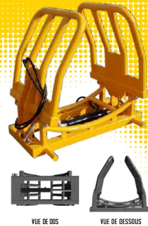
**LA PBER (PINCE BALLES ENRUBANNAGE RONDES)** est une pince spécialement conçue pour saisir et transporter des balles rondes d'enrubannage. Elle offre une prise solide tout en protégeant le film d'enrubannage, permettant un chargement et un déchargement faciles. La PBER est équipée de bras ajustables qui se referment autour de la balle, assurant une manipulation efficace et sans dommage. Le système hydraulique 1 vérin associé aux ressorts
